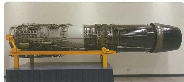
J79-GE-19發動機，為軸流式渦輪噴射發動機，裝用於F-104A戰鬥機上。此型機具備高速飛行續航力，火力及鑽升能力亦極優異。
