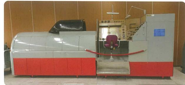
C-11B林克機是一種噴射式飛行模擬機，本機模擬之性能與T-33噴射機相仿，適合次音速各型噴射戰鬥機之儀器飛行輔助訓練。
